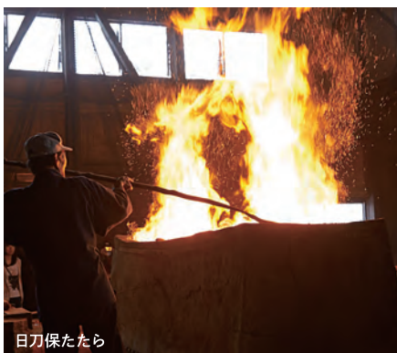
たたら製鉄で精錬される和鋼は、熱処理の過程で弱ることなくより粘り強く美しくするという性質を持っており、古くから刀などを作るのに使われてきました。日本で唯一たたら製鉄の火を守り続けています。
